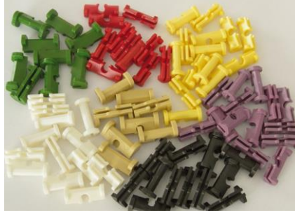
Şekil 1.13. Ring makinasında kullanılan klipsler
