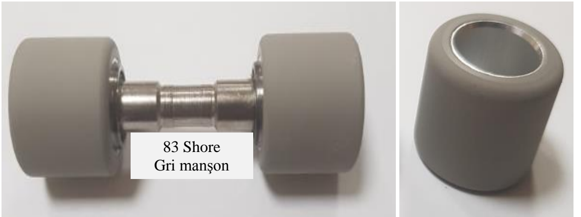
Şekil 3.3. Ring makinesinde kullanılan manşonlar
