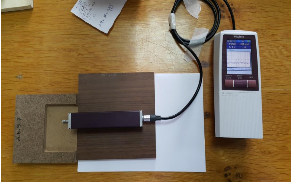
Şekil 3.6. Mitutoyo SJ-210 model pürüzlülük ölçüm cihazı ve test örneği
