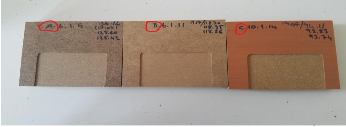
Şekil 4.2. Dalma derinliği aynı (1 mm) olan ve yoğunlukları farklı test örnekleri görüntüsü (A: 758, B: 707 ve C:582 ).
