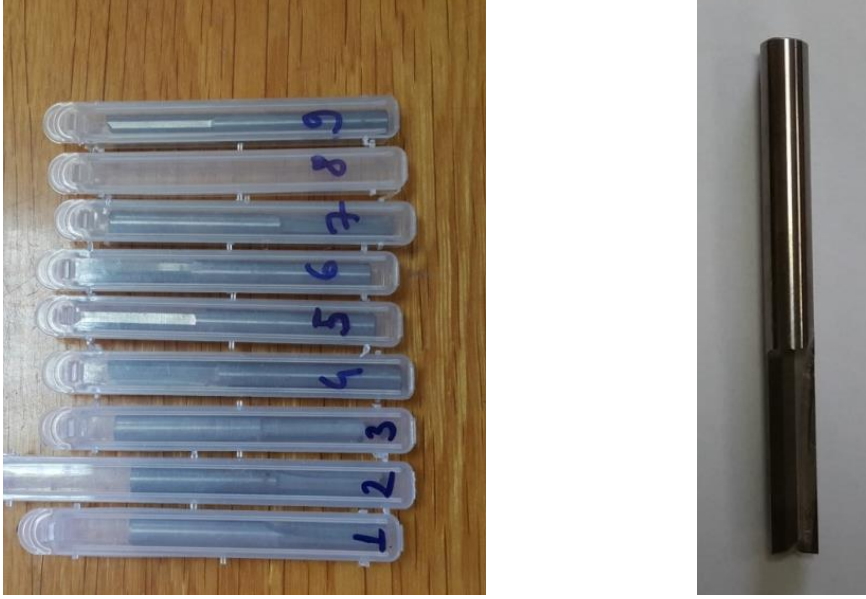
Şekil 3.2. Tarama işleminde kullanılan bıçaklar
