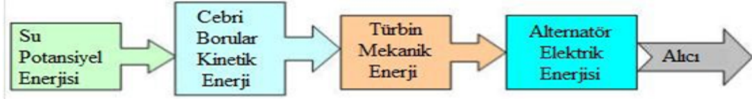
Şekil 1: Hidroelektrik Dönüşüm Şeması [3]
