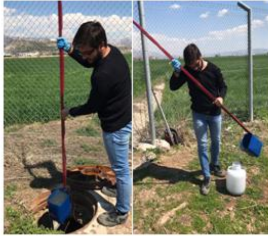
Şekil 3.1 Kahramanmaraş Atıksu Arıtma Tesisi numune alma noktası
