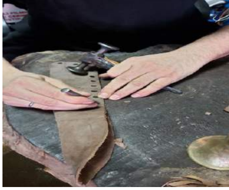
Resim6: Deri ikiye katlanıp karşılıklı olarak örgünün geçeceği delikler hazırlanıyor
