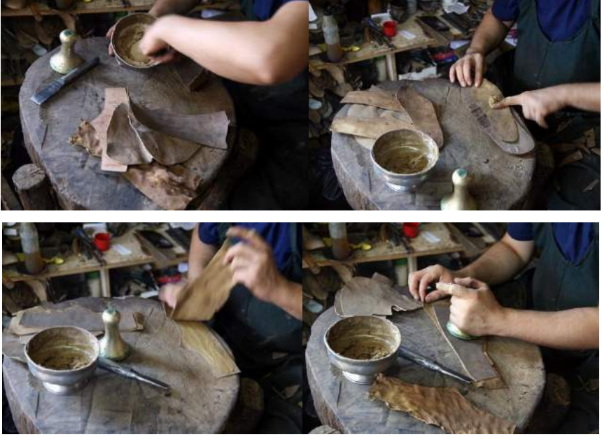
Fotoğraf No:3 Astar ve taban arasına çiriş karışımının sürülmesi
