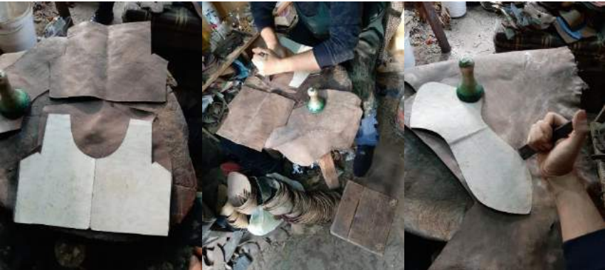
Fotoğraf No:1 Postal Parçalarının Derilerden Kesilmesi
