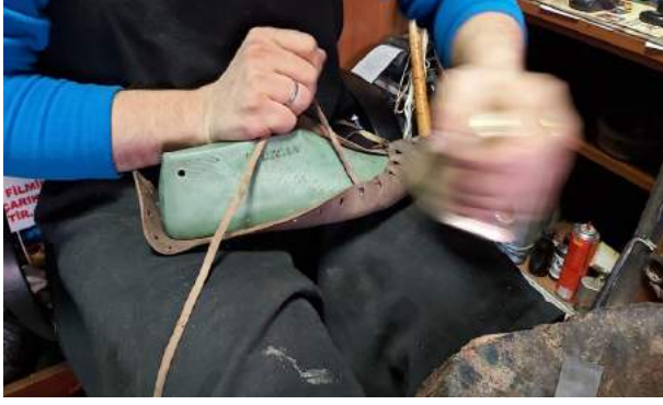
Resim11: Kalıp konularak örülmeye bunu üzerinde devam ediliyor ve derinin kalıba oturması için muştayla eziliyor
