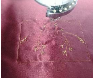
Şekil:36 Sargı parametreleri kullanılarak dijital ortamda tasarlanan Maraş (Dival) işi tekniğinin işleneceği modelin bilgisayar destekli nakış makinesinde yapılan dekoratif dikişlerin görüntüsü.
