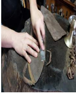
Resim5: Derinin yumuşatılır ve kenarları tıraşlanarak ayağa vurması engelleniyor
