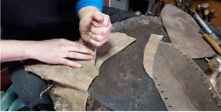
Resim7: Örgü derilerinin bağlanacağı ve ayna kısmını kapatacak deri parçaları kesiliyor
