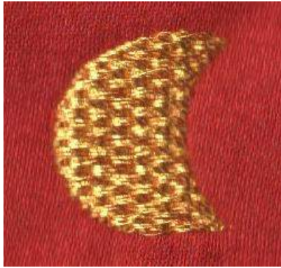
Şekil:29 Sargı parametreleri kullanılarak dijital ortamda tasarlanan hasır iğne tekniğinin bilgisayar destekli işleme makinesinde işlenmiş görüntüsü.
