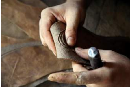
Fotoğraf No:4 Dikiş Kanalının Hazırlanması
