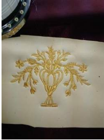
Şekil:39 Sargı parametreleri kullanılarak dijital ortamda tasarlanan Maraş (Dival)ışı tekniğinin kabarcık durması için işlemenin altına konulan evanın üzerine bilgisayar destekli nakış makinesinde yapılan işlemenin bitmiş görüntüsü.
