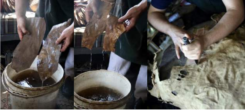
Fotoğraf No:2 Kesilen Derilerin Suyla Islatılması
