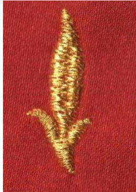
Şekil:18 Sargı parametreleri kullanılarak dijital ortamda tasarlanan yarma sarma tekniğinin bilgisayar destekli işleme makinesinde işlenmiş görüntüsü.
