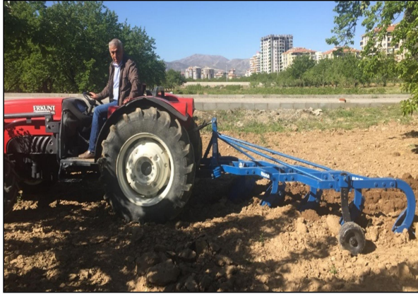
Şekil 3.3. Denemede kullanılan kulaklı pulluk ve teknik özellikleri
