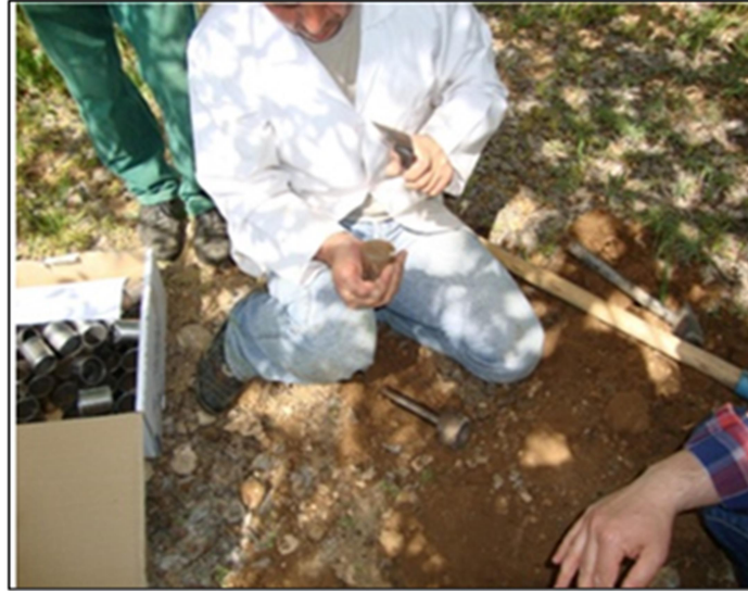
Şekil 3.20. Çalışmanın yürütüldüğü deneme alanından bozulmamış toprak örneği alma işlemi
