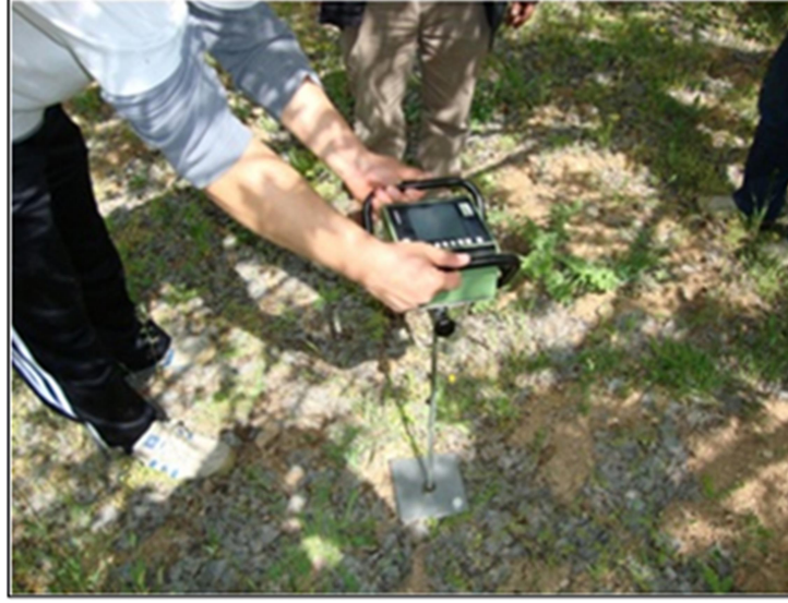
Şekil 3.18. Penetrasyon direnci ölçme işlemi
