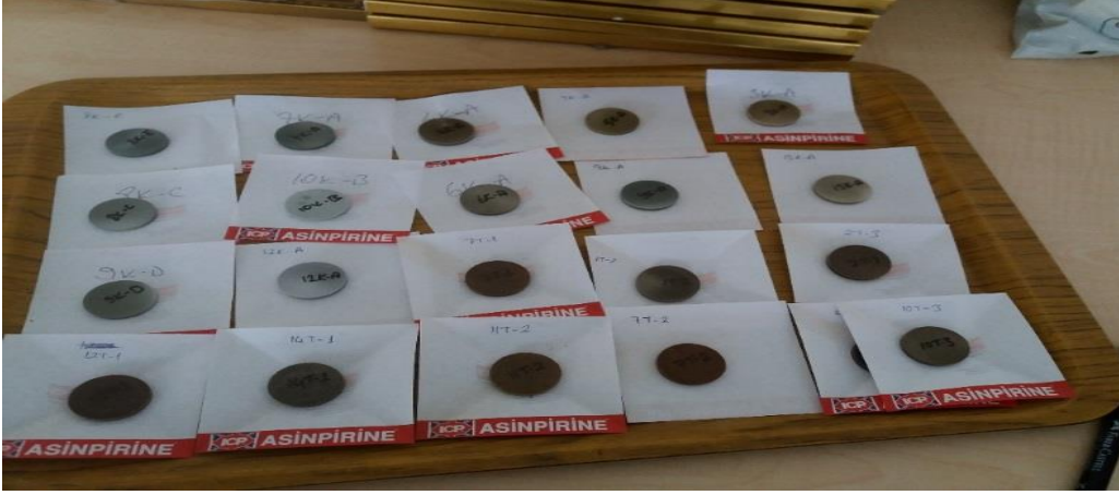
Şekil 7. Örneklerin analize hazırlanması
