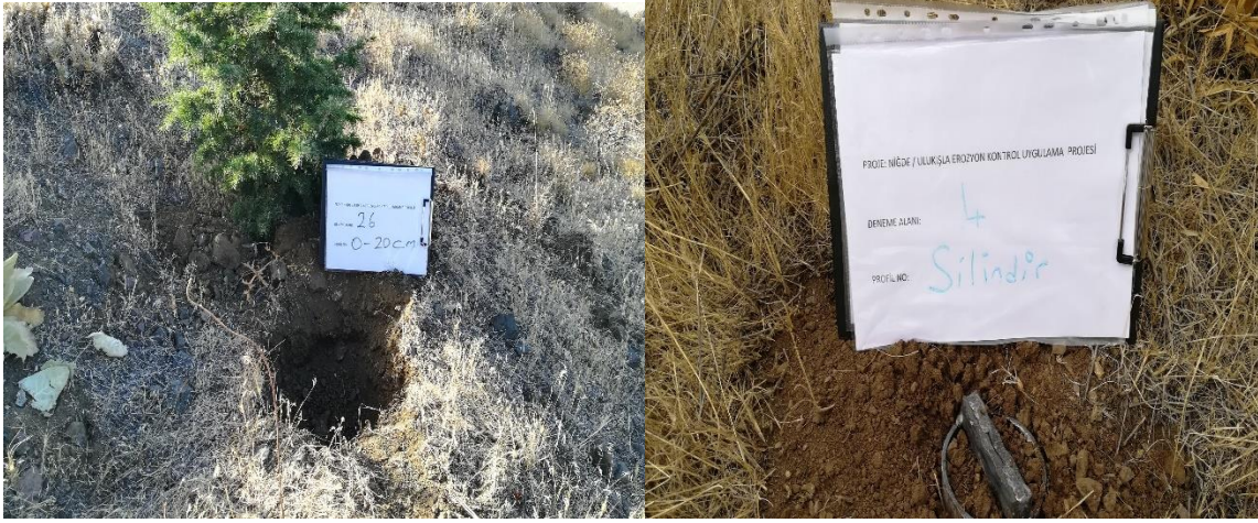
Şekil 6. Bozulmuş toprak örneğinin ve silindir örneğinin alınması
